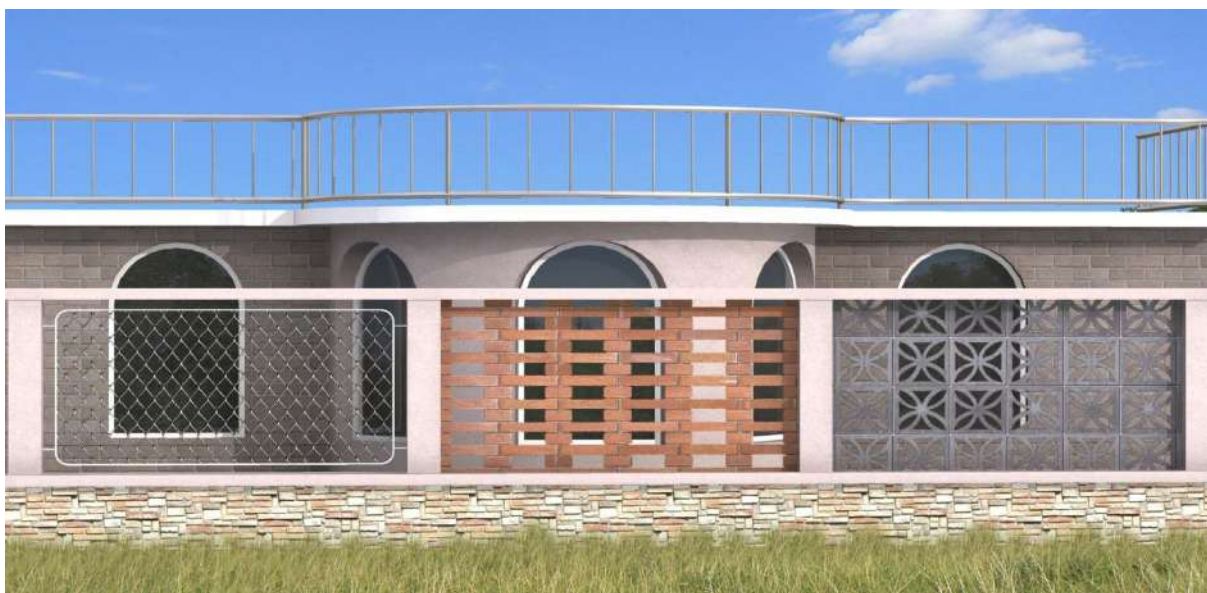
Прозирни текстури във вид на мрежа, тухлен зид и зид от бетонни блокчета
